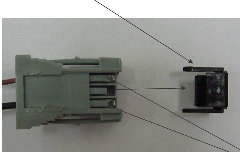
Mit einem kleinen Schraubenzieher (2,5mm Klingenbreite) die Laschen anheben und die Kabel nach hinten herausziehen.
