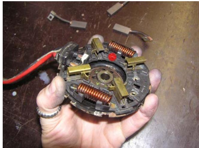
Ebenso sind die Anschlussfahnen gezielt zu verlegen und bei der Montage eine Beschädigung der Silikonisolierung zu vermeiden. Hier kann es sonst zwischen Anschlussfahne und Motorgehäuse zum Kurzschluss kommen.
