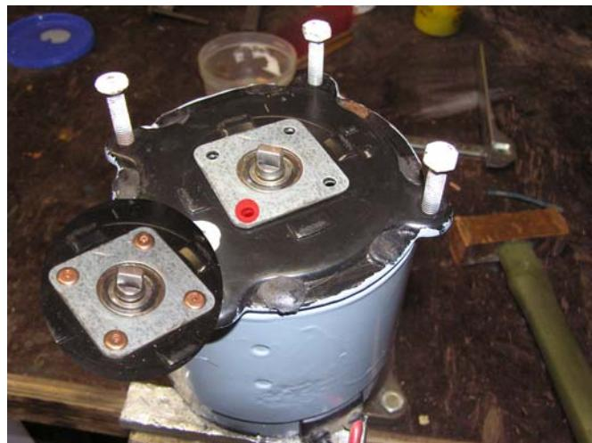
Achtung: bevor man die Motorwelle austreibt sollte man mit einem Meßschieber das Maß nehmen, wie weit die Motorwelle aus dem Motorgehäuse heraus steht. Wenn man den Anker beim Zusammenbau nicht weit genug zurück in Richtung Lagerschild treibt bekommt man den Deckel auf der Rückseite nicht mehr zu!
