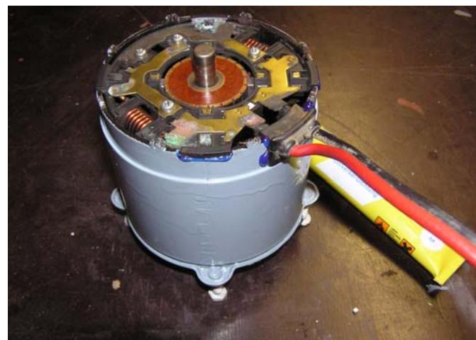
Danach das Lager des Ankers im Deckel fetten, Deckel aufsetzen und vernieten.
