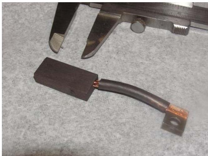
Hat man die Kohlen passend geschliffen, kann man sie mit den Wickelfedern einsetzen und prüfen ob's flutscht.. nicht vergessen die Kanten der Kohlen anzufasen da die Kohlenträger in den Kanten leicht rund sind.
