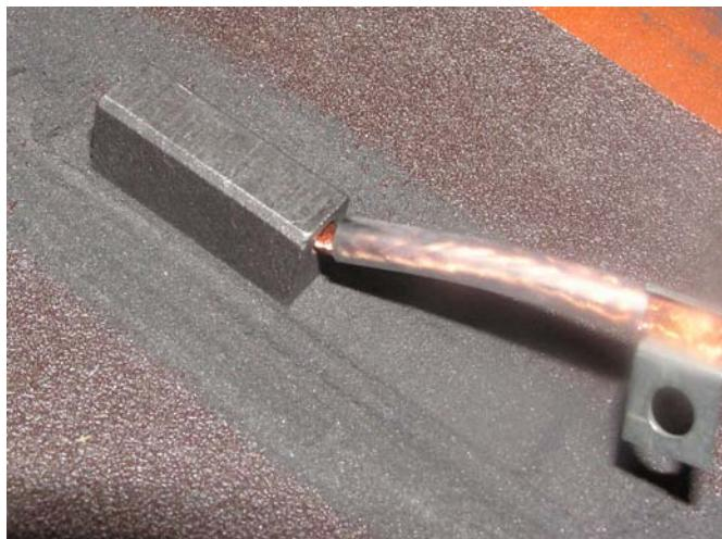
Vorsichtig schleifen die Kohlen schwinden zusehends, ständiges Kontrollieren mit dem Meßschieber. Bei dieser Arbeit ist Feingefühl gefragt.
