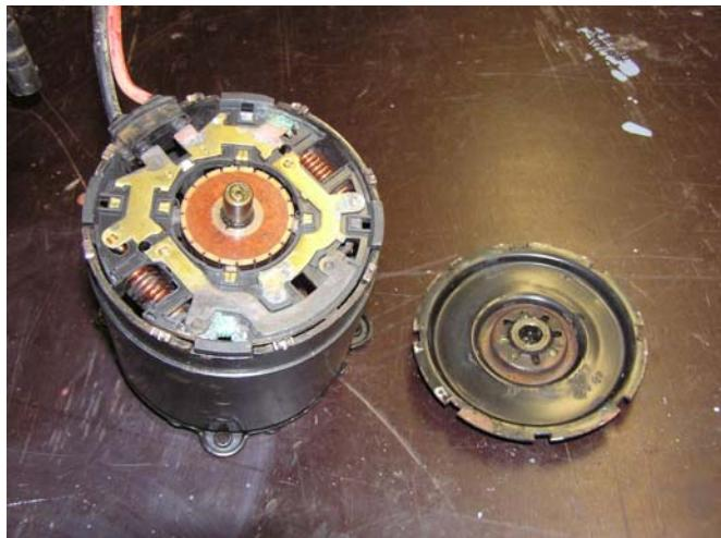
Die Trägerplatte lässt sich einfach nach oben abziehen. Vorsicht mit den Wickelfedern, bei zu kurzen Motorkohlen können diese Herausfallen oder schlimmer noch wegspringen. In meinem Fall sind die Motorkohlen bereits so kurz, dass die Wickelfedern nicht mehr genug Kraft aufbringen können um die Kohlen an den Anker zu drücken. Das ist der Grund für das Versagen meines Motors.
