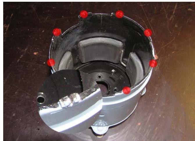
Nun kann ich nach dem Aufsetzen des Deckels die Nieten bequem mit einem schmalen Schraubendrehen den ich in den gesägten Schlitz stecke auseinander treiben. Diese Verbindung hält den Motor ausreichend zusammen.
